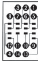
Klemmenbelegung/ Interne Beschaltung (Ansicht von oben)
