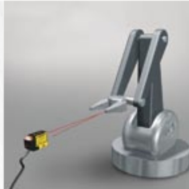
Posities van repeterende robotarm inleren voor ijking
