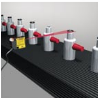
Aanwezigheid van de O-ring in het montageproces
