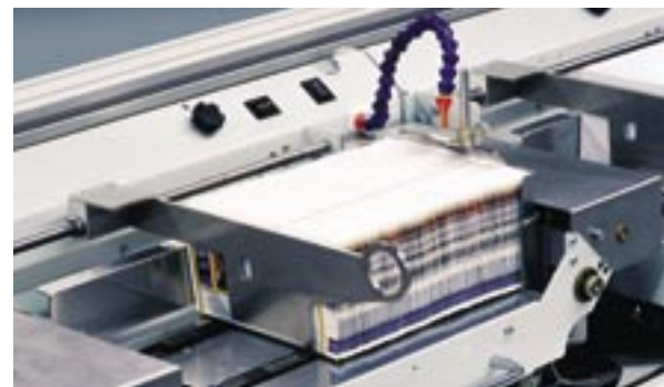
Le contrôle des pièces jointes est réalisé par les postes individuels d'insertion.
