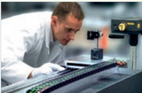
Precisionsmätning med laserinterferometer för kvalitetssäkring när data för stegfördelning skapas.
