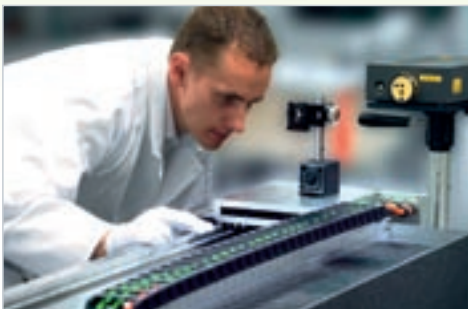
Presisjonsmåling med laserinterferometer for kvalitetssikring for å opprette data for stadietilordning.
