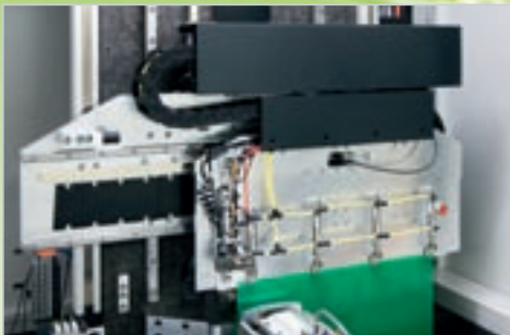
Lineære motorkomponenter med jernkjerne i kretskortproduksjon for svært dynamisk og presis posisjonering av verktøy og PCB-er.
