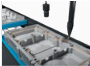
FlexXpect-Glue Bead: Otomatik yol hesaplama ile tüm parçaların basit denetimi
