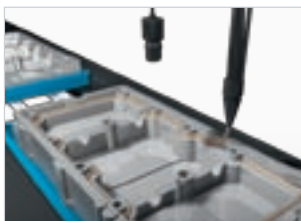
FlexXpect-Glue Bead Semplice ispezione di parti complete mediante calcolo automatico del percorso
