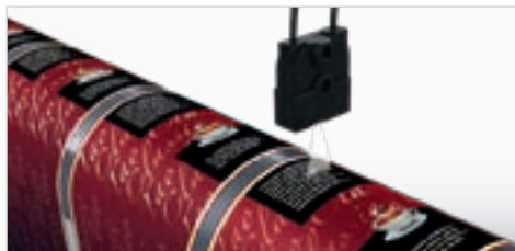
Testina in fibra ottica per lunghe distanze E32-L15 e il nuovo LED dell'E3X-DAC-S per il rilevamento di colori e marcature complessi
