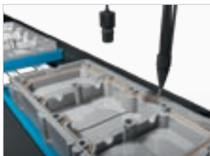
FlexXpect-Glue Bead: Teljes alkatrészek egyszerű vizsgálata automatikus pályakiszámítással
