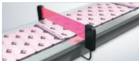
Fonction de bord différentielle pour la détection de changements rapides de hauteur
