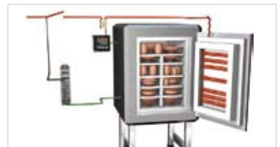
Temperaturüberwachung 'Polizist' mit Sperren.
